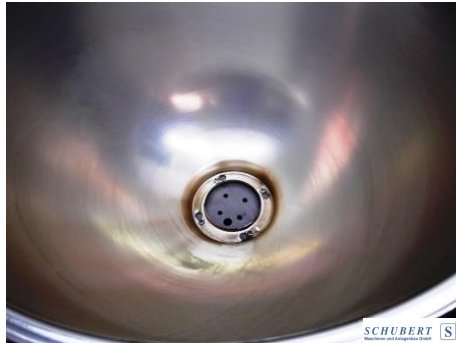
HQL Leuchte montiert
